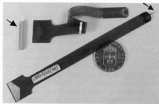
Abb. 5: Das speziell angefertigte Polyimid-Verbindungskabel zwischen einer Sonde U1 (Pfeil) und einem ZIF-Adapter der Firma Molex (Pfeil mit Doppellinie). Die schwedische Krone dient als Maßstab.
