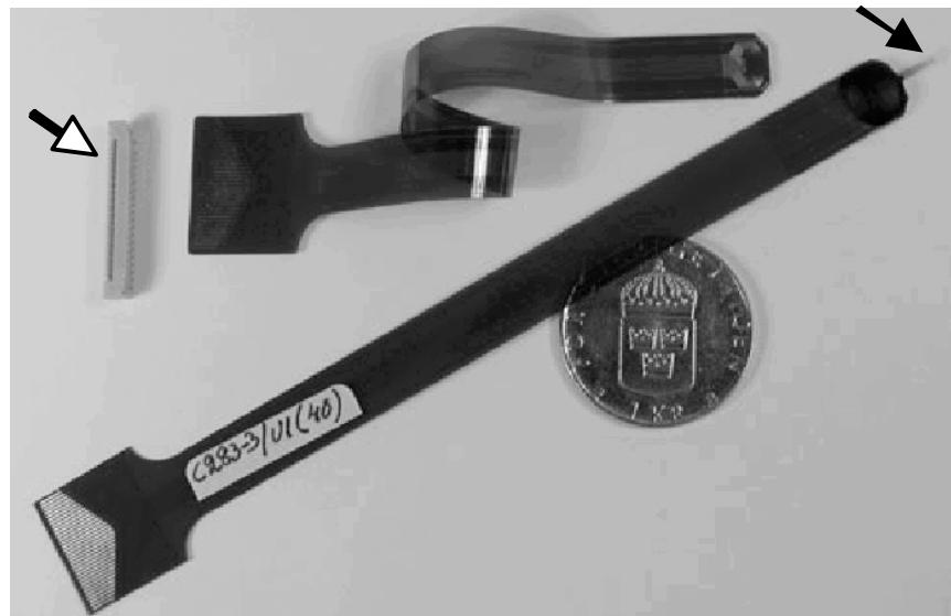
Abbildung 13: Das Kapton®-Verbindungskabel zwischen einer Sonde U1 (Pfeil) und einem ZIF-Adapter der Firma Molex (weisser Pfeil). Die schwedische Krone dient als Veranschaulichung des Maßstabs.
